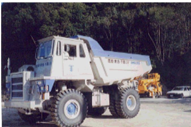
写真-6 坑内用ダンプトラック（リジットタイプ）
