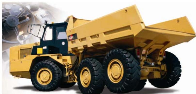
写真-7 坑内用ダンプトラック（アーティキュレートタイプ）
