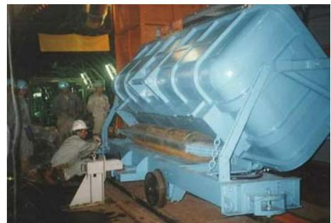
写真-9 転倒式鋼車
