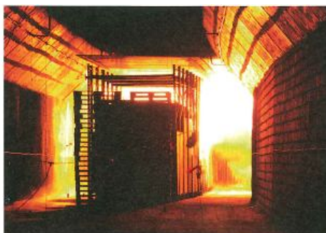
参考図 実トンネルでの耐火試験の様子
