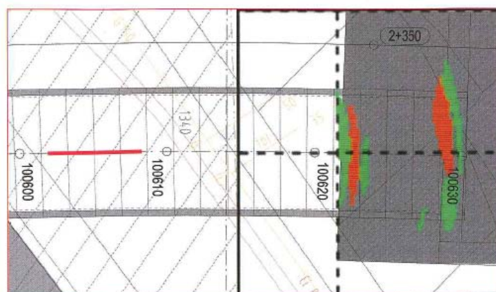
9 Detektion der Vorder- und Hinterkante eines Dichtblocks 9 Detecting front and rear edges of a sealing block
