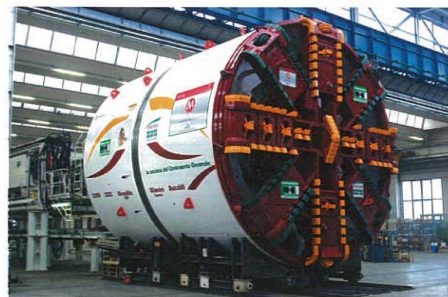
ライン C で使われた EPB シールド(直径 6.69m)
