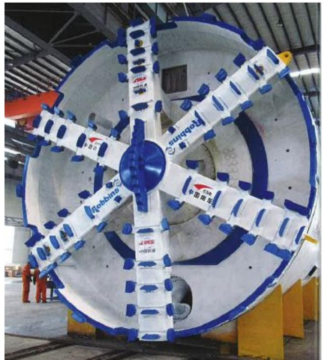
写真-1 1号線で使用した泥土圧シールド機
