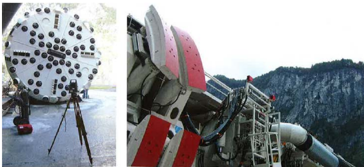
図-4 アクセス用トンネルに使用した直径 8.03m の硬岩用 TBM 機
