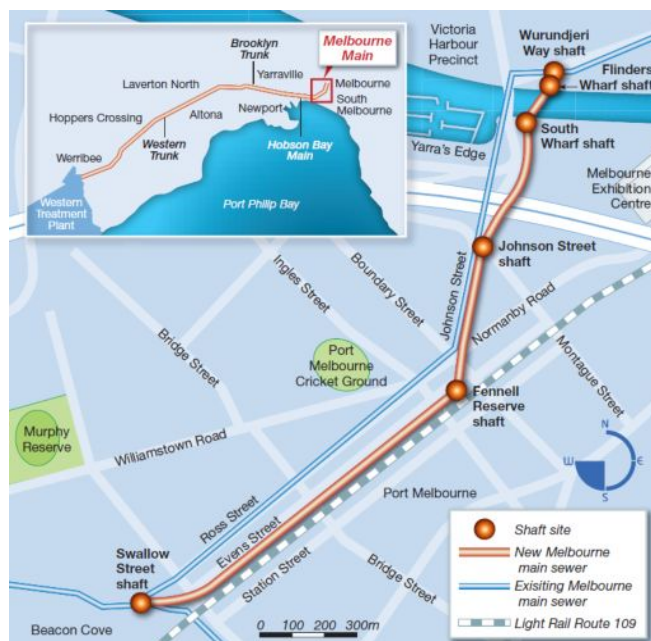
図-1 既存と新設の下水道管敷設図
